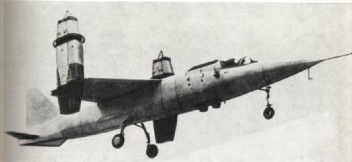
19. Un tipo di aeroplano VTOL a reattori oscillanti: il caccia germanico supersonico sperimentale Entwicklungsring Süd EWR-VJ-101-C (1963), durante la fase del decollo verticale.
