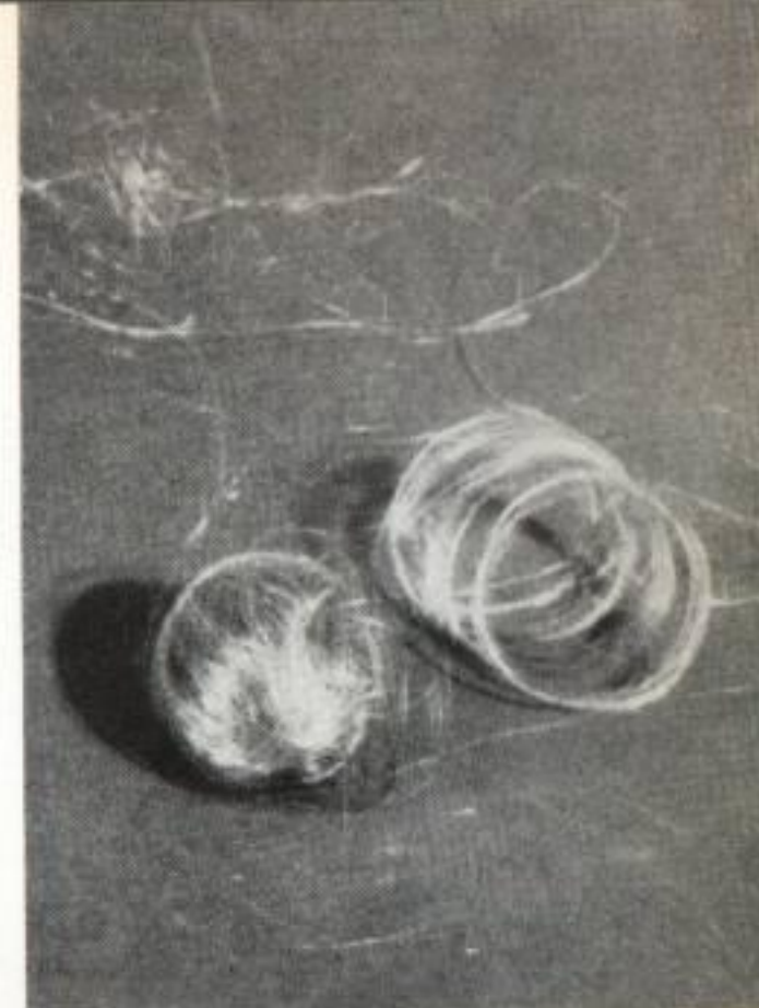
33. Altri campioni di « paglia metallica antiradar » usata come mezzo di disturbo elettronico passivo.
