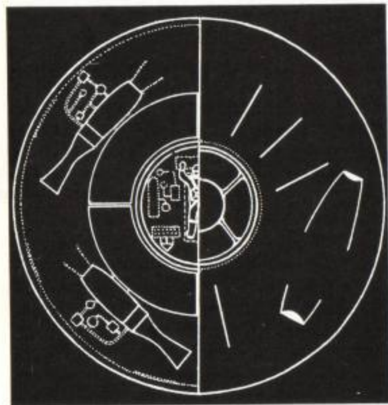
40. Schema del preteso «discoplano» germanico da caccia, derivato dal turboproietto italiano e propul- so da turboreattori periferici ro- tanti.
