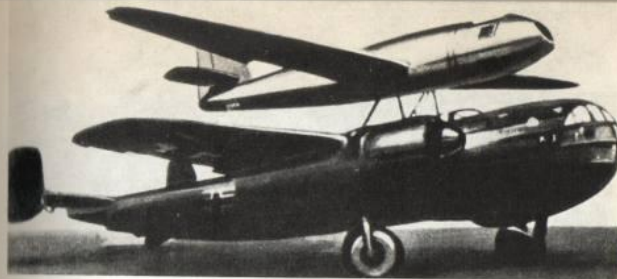
10. Il composito tedesco da ricognizione strategica costituito da un monoplano Siebel-D.F.S.228 montato su un bimotore Dornier DO.217.K.
