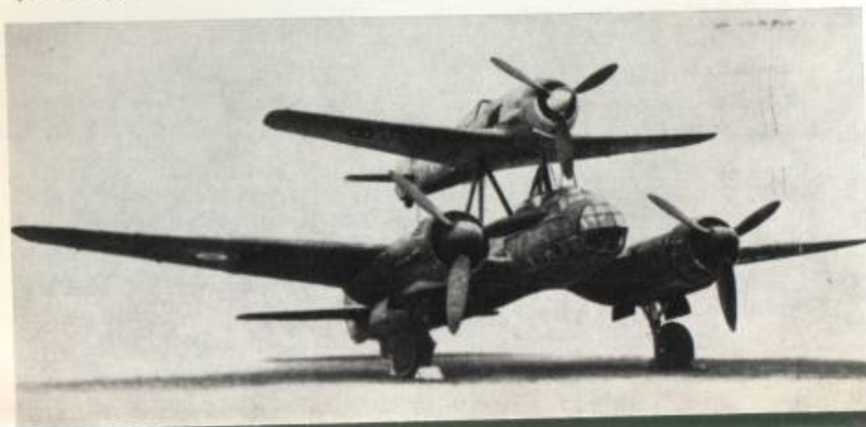
9. Un composito tedesco da bombardamento della serie « Mistel-Flugzeuge » caduto in mani inglesi, costituito da un caccia Focke-Wulf 190 montato su un bimotore Junkers 88 .
