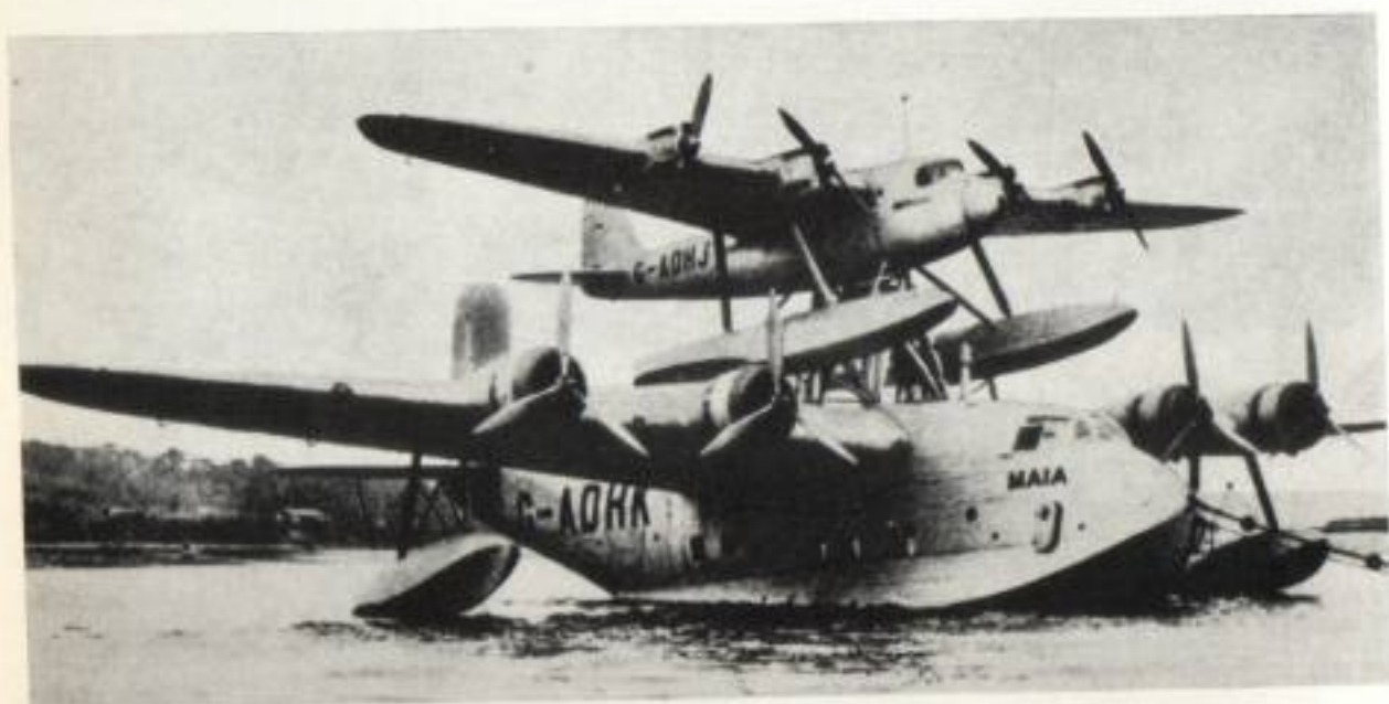
8. L'aeroplano composito Short « Mercury-Mayo » : un quadrimotore postale transatlantico montato sul dorso di un grande quadrimotore Empire a scafo centrale.
