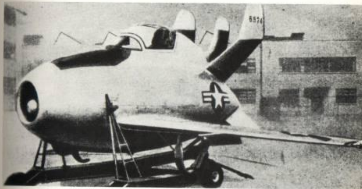
11. Il «caccia parassita» americano Mc Donnell XF-85, che si sganciava e riagganciava in volo su un trapezio montato su un quadrimotore B.29.
